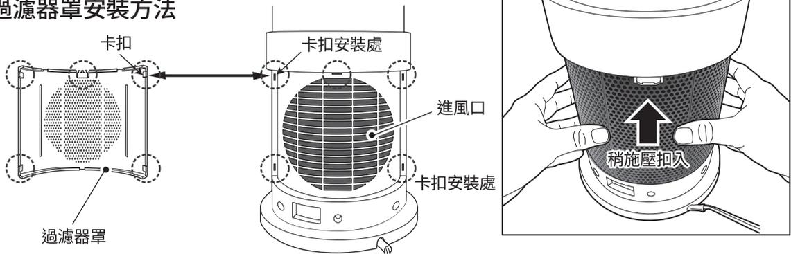
確認過濾器罩的卡扣位置後，對準主體的安裝處，稍作施壓後即可安裝完成。
