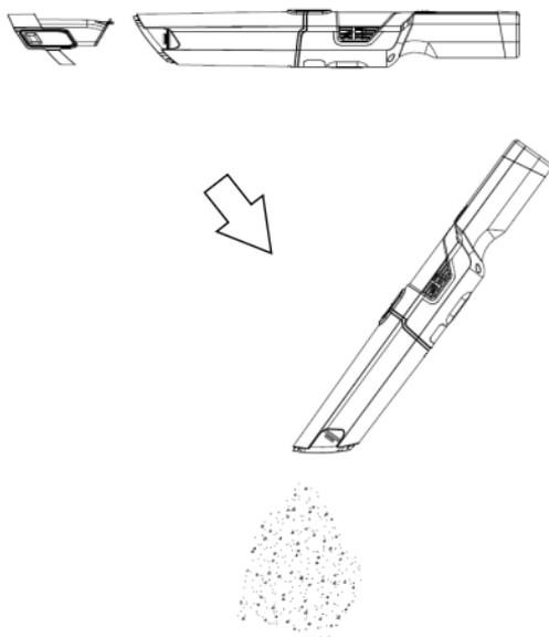
2. 按壓塵杯鎖扣按鈕，取下塵杯。
