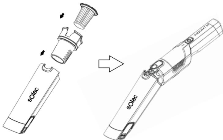
**\*重要：請確保HEPA濾網和塵杯完全風乾，再裝回設備。**
