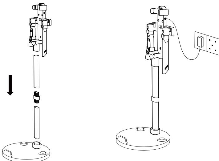
將收納架靠牆組裝好後，將機器放在架上，並把配件放入充電座左右插槽中。
