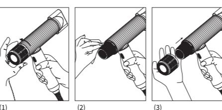
將⑤過濾蓋逆時針扭開，從吹風機主體的進氣口取下。使用布或刷子，擦去內部濾網和⑤過濾蓋上累積的灰塵。
