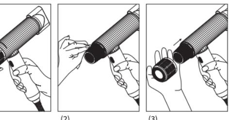
將 **5** 過濾蓋 逆時針扭開，從吹風機主體的進氣口取下。使用布或刷子，擦去內部濾網和 **5** 過濾蓋上累積的灰塵。重新順時針將 **5** 過濾蓋安裝後，即可使用。
